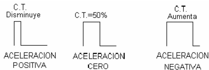
Figura 6.21 Variaciones del ciclo de trabajo debidas a las variaciones de la aceleración
