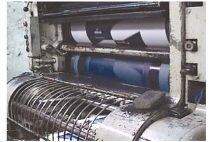
Rodillos del offset, se puede ver la diferencia entre el rodillo que porta la lámina y el blanket de color verdoso y en la parte inferior de la imagen, la salida de las imágenes.
