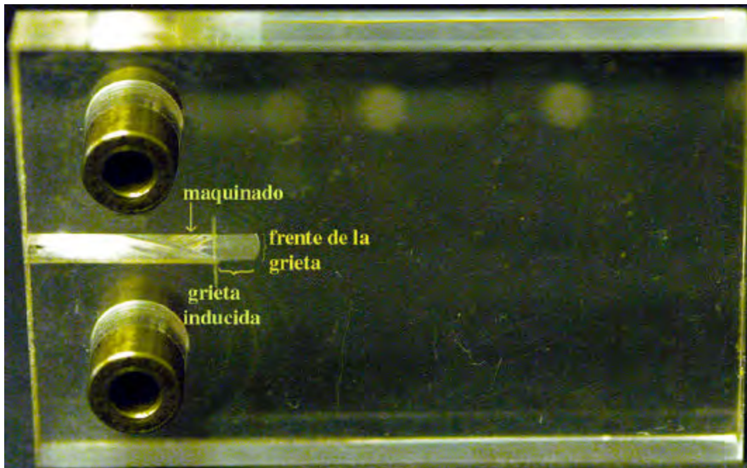
Figura 2.26. Probeta de PMMA de 6mm mostrando los detalles del maquinado y la grieta inducida.
