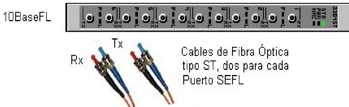
Figura 5.4. Interfaz Ethernet 10BASE-FL.
