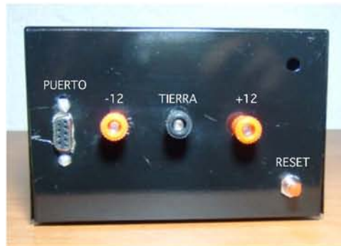
Figura C.2: Descripción de terminales del panel trazero.
