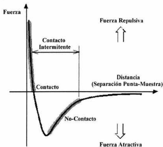
Fig. I.5.2. Curva de fuerza interatómica vs. separación punta-muestra.
