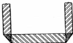
Ejemplo de Soldadura de Esquina Sometida a Esfuerzo Flexionante.
