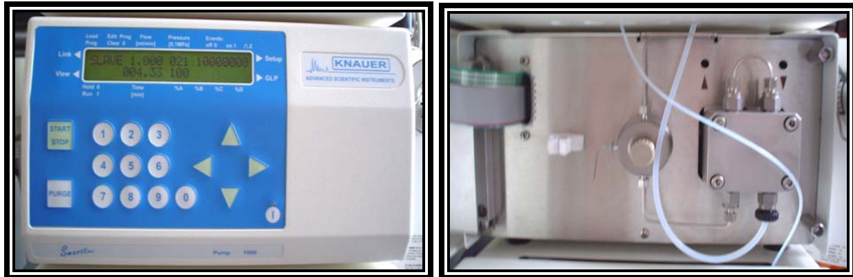
Figura 5. Sistema de bombeo del cromatógrafo de líquidos marca Knauer y cabezales de los pistones de la bomba (derecha).
