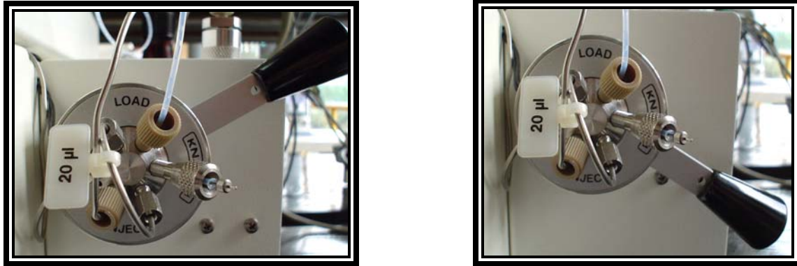
Figura 6. Válvula de inyección en posición de carga (izquierda) y en posición de inyección (derecha).
