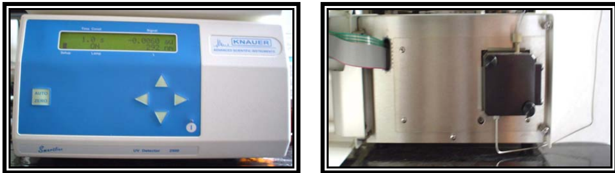
Figura 9. Detector de UV-Visible de longitud de onda variable marca Knauer y a la derecha la celda de flujo.
