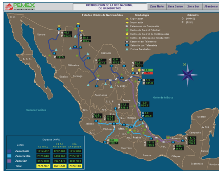
Fig. II .6 Pantalla de monitoreo del cuarto de control principal del SCADA de la Red Nacional de Gasoductos y LPGductos
