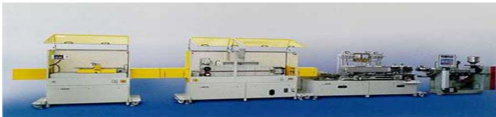
**Figura 18 : Línea de extrusión típica formada por ( derecha a izquierda ) extrusor, unidad de enfriamiento / dimensionamiento, unidad de tracción y unidad de corte ( Bayer A.G.)**
