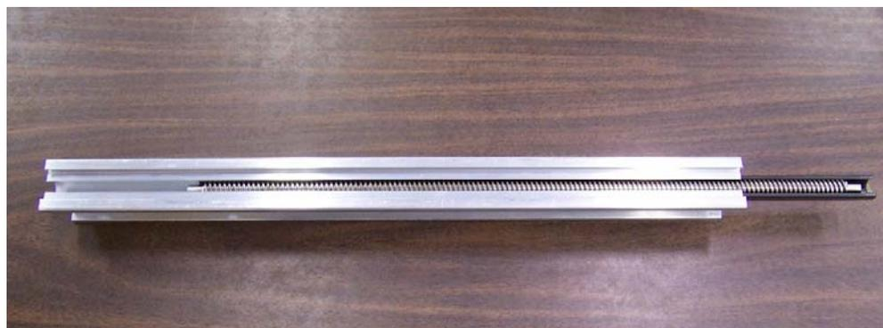
Figura 10 : Cubierta o "liner" plástico para transmisión de tornillo sin fin
