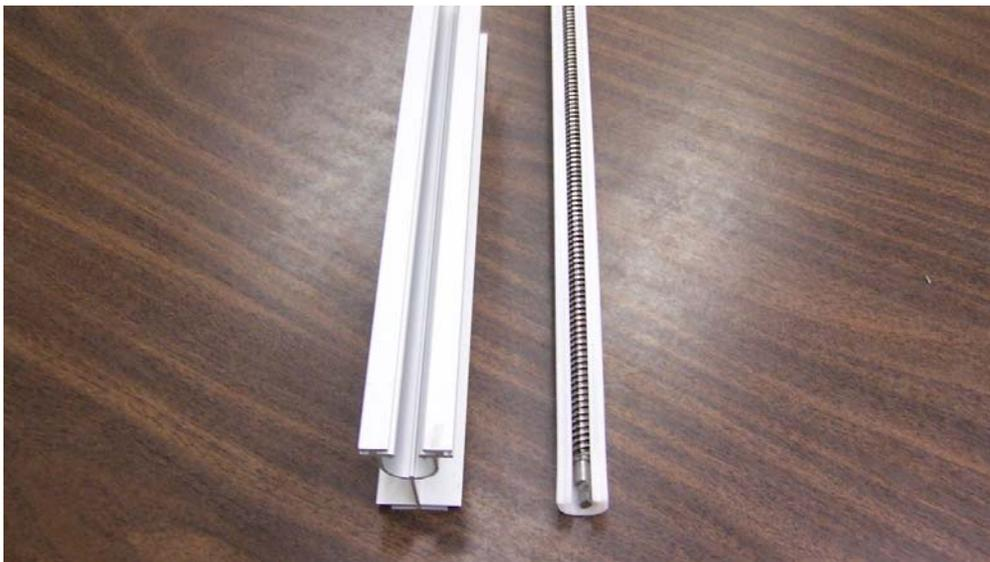
**Figura 11b : Fotografías cubierta plástica “liner” Chamberlain.**
