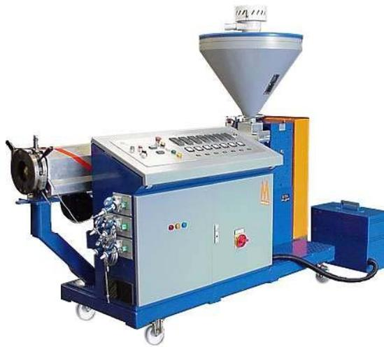
**Figura 19 : Vista de extrusor de 1 sólo tornillo típico ( Cortesía de Luigi Bandera SpA )**
