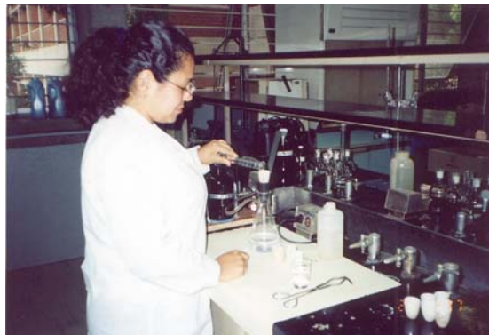
Foto IV.13 Obtención de los sólidos suspendidos.
