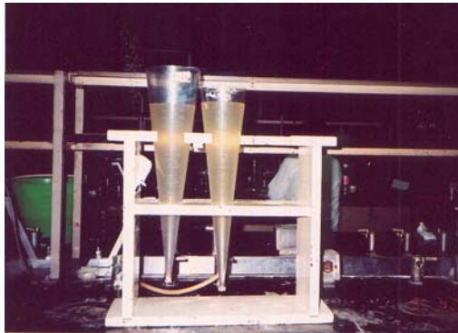
Foto IV.7 Sedimentación de los sólidos en los conos Imhoff.
