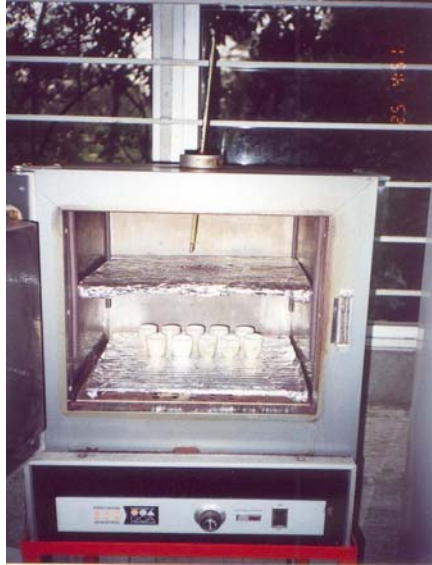
Foto IV.14 Sólidos colocados en la estufa a una temperatura de 103-105 °C.
