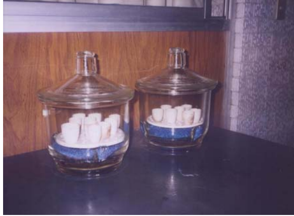
Foto IV.10 Desecador con crisoles Gooch.
