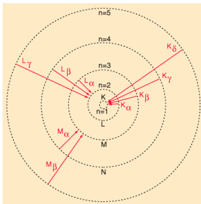
Figura 3. Transiciones energéticas de los rayos X. En átomos pesados, la transición de electrones de niveles atómicos altos a niveles atómicos bajos tienen energías ubicadas en la región de los rayos X del espectro electromagnético. La emisión de rayos X asociada con esas transiciones son llamadas rayos X característicos.
