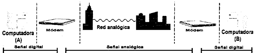
Figura 1-4. Transmisión de señales digitales por redes analógicas.
