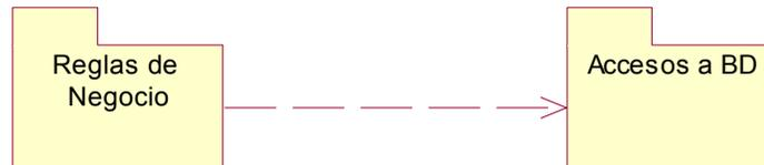
En este caso el paquete *de reglas de negocio* depende del paquete de *acceso a base de datos*, un cambio en los elementos de *acceso a base de datos* afecta o puede afectar al paquete *reglas de negocio*.
