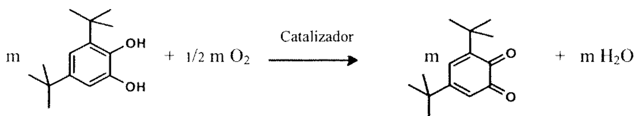
Figura 3.20 Reacción modelo: oxidación del 3,5-di-ter-butilcatecol .
