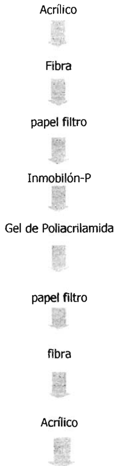
Figura 4. Colocación del Sistema de Electrotransferencia
