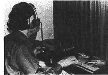
IMAGEN 1.18: Manera de realizar fácilmente el montaje con ayuda de dos magnetófonos.
