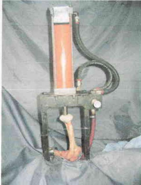
Figura 4: Prensa Neumática
