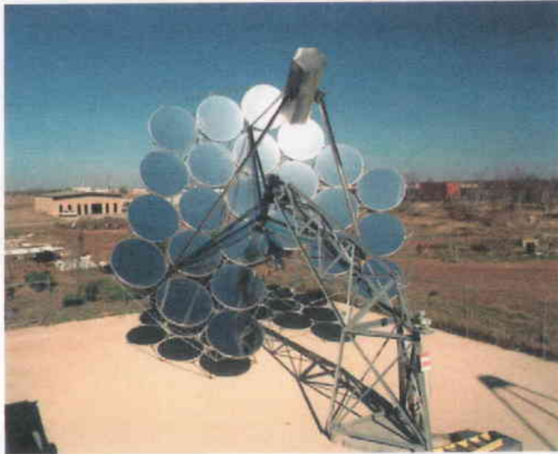
Figura 4.22. Este sistema cuenta con helióstatos desarrollados por el Laboratorio Nacional de Energías Renovables de los EU (NREL, por sus siglas en inglés). Los helióstatos proyectan los rayos solares sobre un receptor colocado sobre el centro del disco integrado por dichos helióstatos.
