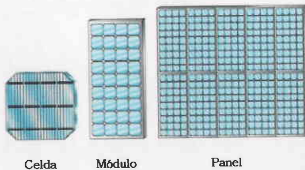
Figura 4.24. Evolución desde la celda solar hasta el panel fotovoltaico.
