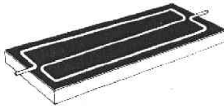
Figura 4.5. Circuito de tubos montados sobre la superficie absorbente.
