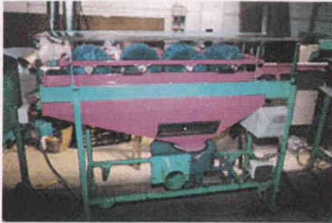
Figura 35. AGRILUX 4000 SPECIAL para higos chumbos con cepillos superiores motorizados, aspirador centrífugo inferior y cinta motorizada de empuje en la entrada.
