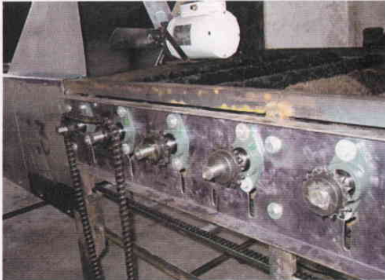
Figura 43. Ensamble de cepillos.
