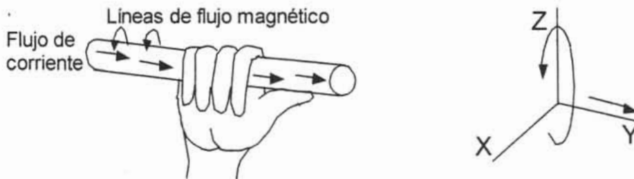
Figura I.7. Ley de Ampere o de la mano derecha.
