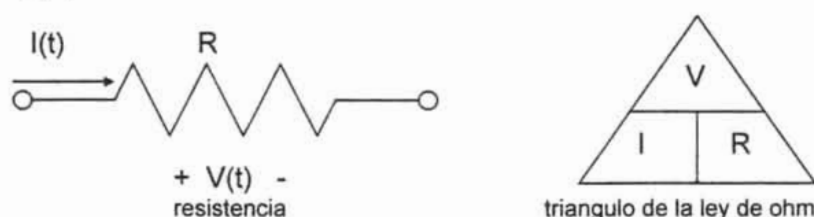
Figura I.17. Relación entre voltaje, corriente y potencia (ley de ohm).
