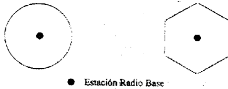
TIPO DE COBERTURAS DE LAS ESTACIONES BASE RBS GSM1900
