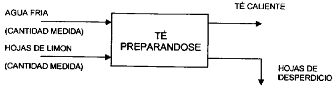
Figura II.1.1.3. Modelo de caja negra para la preparación de té.
