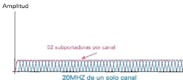
Figura II.32 Multiplexión por división ortogonal de frecuencia, OFDM<sup>31</sup>
