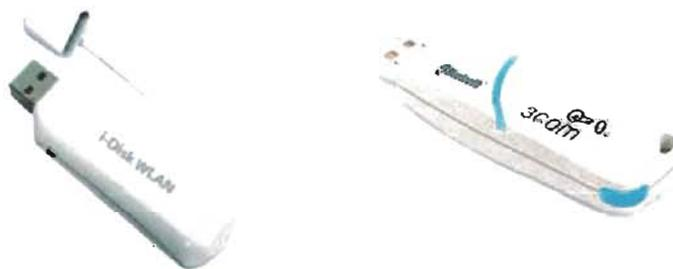
Figura II.5 Adaptadores de red inalámbrica para USB
