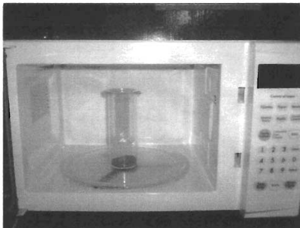
Figura 7. Montaje experimental para irradiación de microondas. 19
