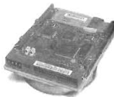
Fig. 15 Los discos duros se encuentran en un recipiente sellado al vacío para evitar el contacto de la cabeza de lectura
