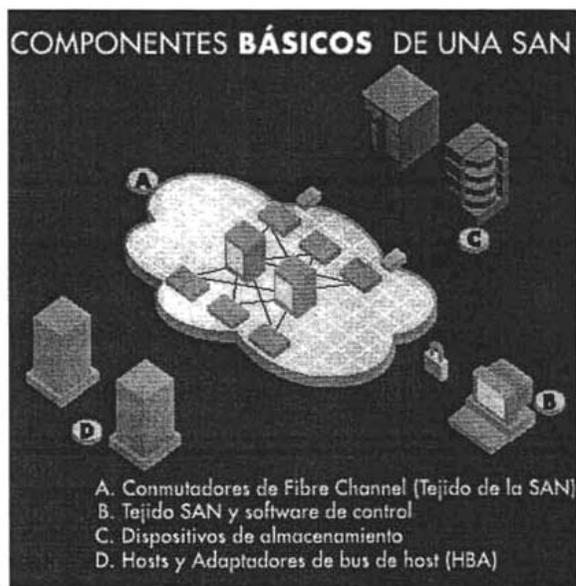
figura 1.12 Configuración de una red SAN
