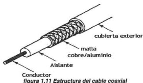
figura 1.11 Estructura del cable coaxial
