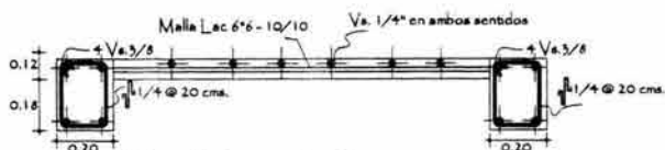
Detalle Losa de Cimentacion
