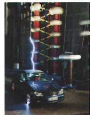
Fig.21 Aislamiento eléctrico dell objeto relacionado con el entorno de uso para proteger all usuario
