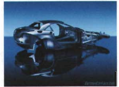
Fig.27 Chasis del Mercedes SLR fabricado en fibra de carbono: lo último en tecnología de materiales.
