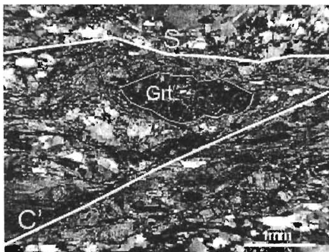
Figura 150. Mica-esquisto con granate. Se aprecia un porfidoclasto muy elongado de granate, cristales de fengita (con subgranos y extinción ondulante), cristales de zoisita y cuarzo con intensa recristalización dinámica. Hay un clivaje en bandas de cizalla S-C' con S horizontal y C' diagonal (superior derecha a inferior izquierda) el cual indica un sentido de cizalla siniestra.
