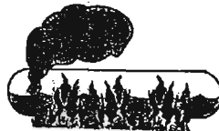
(c) Falla subsiguiente del Recipiente
