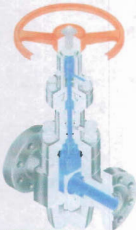
Figura 1 Válvula de compuerta vástago ascendente/compuerta expandida.
