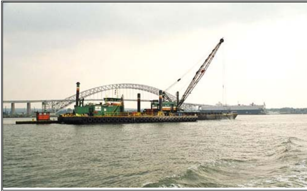
Figura 10. Draga con cucharón de arrastre
