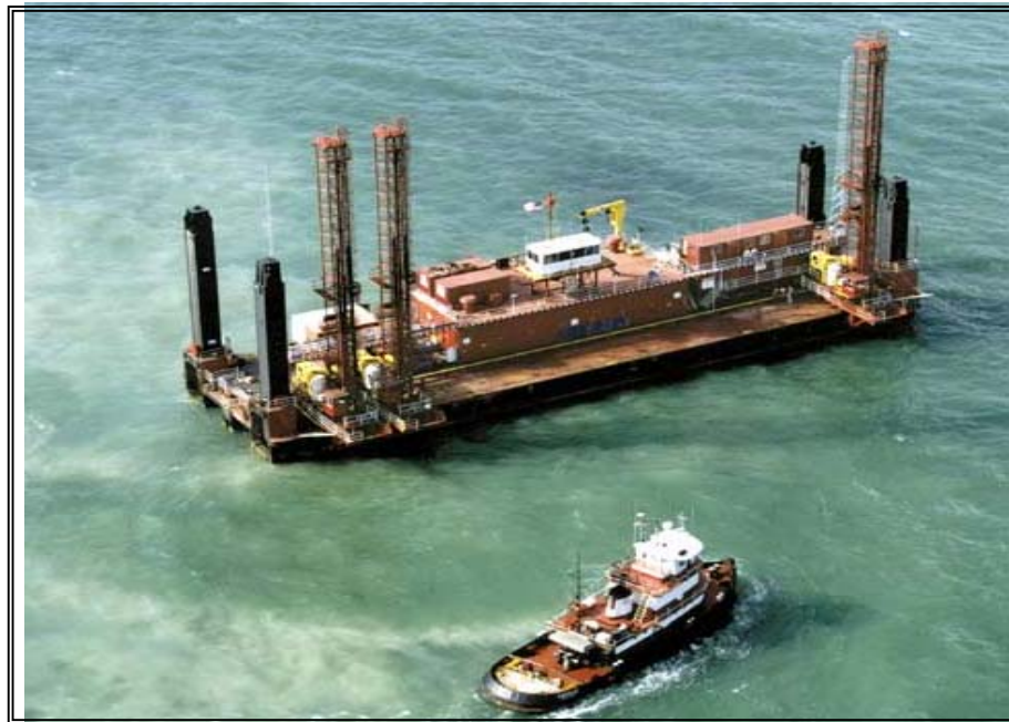
Figura 6. Plataforma autoelevable con tres torres de perforación.
