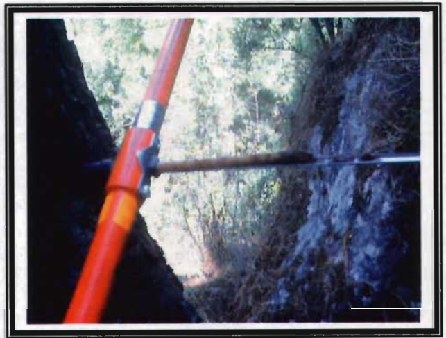
Figura 15: Perforación del árbol con el taladro Pressler Figura 16: Extracción y obtención del núcleo
