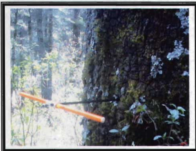
Figura 15: Perforación del árbol con el taladro Pressler Figura 16: Extracción y obtención del núcleo
