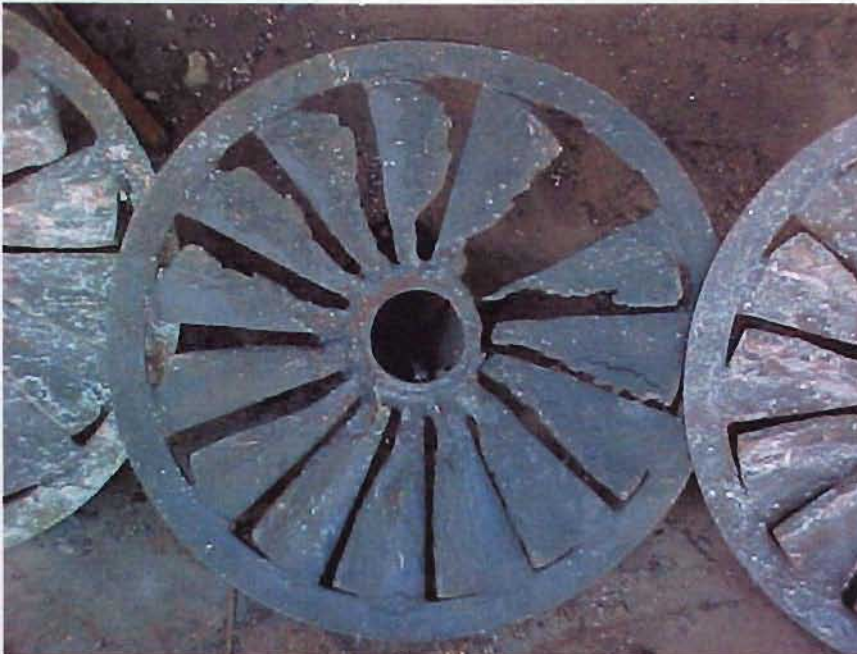
Figura 1.11 Deterioro del estabilizador Bluff Body después de seis meses de operación.
