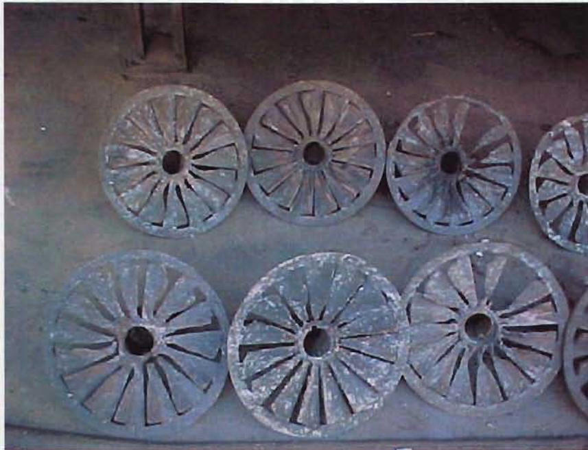
Figura 1.12 Desgaste de los estabilizadores Bluff Body del generador de vapor.
