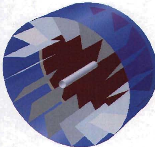
Figura 5.2 Registro de aire del quemador del generador de vapor.
