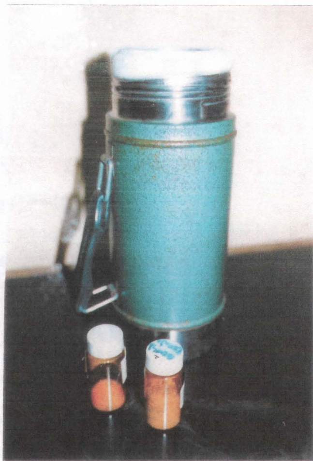
Foto No.8. Los viales con las sales congeladas están fuera del recipiente Dewar, para tomar una muestra para su análisis.
