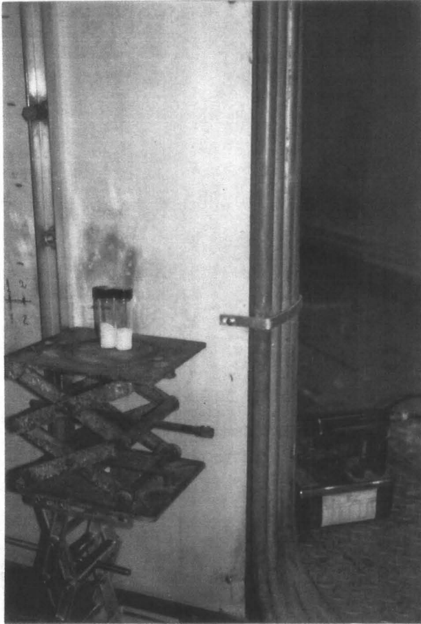
Foto No.3. Posición seleccionada en la cámara de irradiación para el desarrollo de este trabajo. Las muestras se colocan sobre el soporte metálico.
