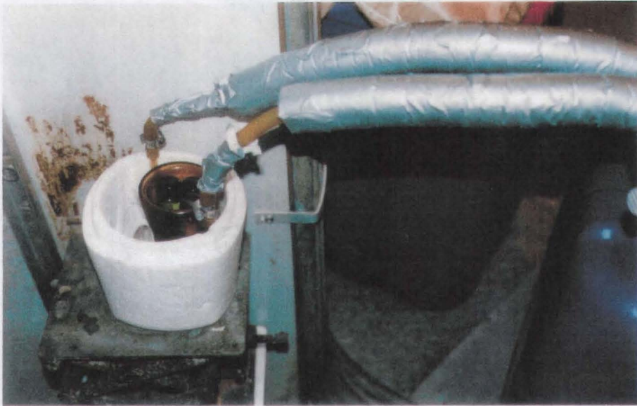
Foto No.7. Las sales ferrosas contenidas en los viales están en el intercambiador de calor por el que fluye el líquido refrigerante.
