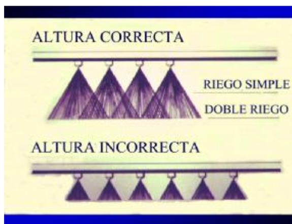
Las boquillas de las espreas deberán aplicar un riego uniforme y sin discontinuidades de liga de asfalto ahulado en la superficie tratada, y serán operadas por un control interno de válvulas de acción directa que permita rápidamente abrirlas o cerrarlas.
