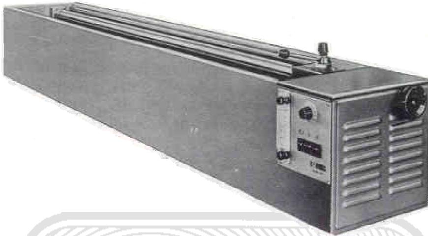
FIGURA 1.- Ductilómetro
