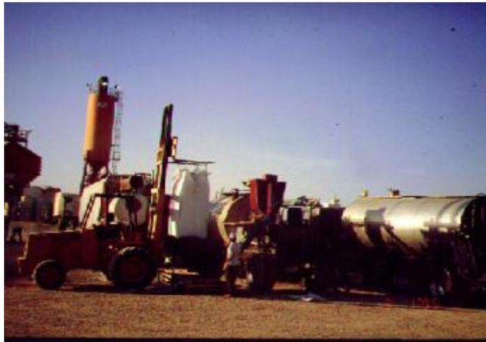
**Sistema de abastecimiento:** Consistente en un tanque equipado con una bomba y equipo de medición integrado adecuado para adicionar el asfalto ahulado al agregado por volumen en la cantidad determinada o requerida cuando se elaboran concretos asfálticos en plantas de concreto asfáltico tanto de bacha como continuas.
