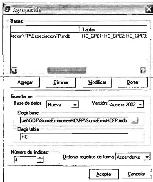
Figura III-42. Ejemplo de configuración de la ventana de agrupación del SPEA, para la suma de emisiones de HC de fuentes puntuales. (archivo "EspeciacionFP.mdb").
