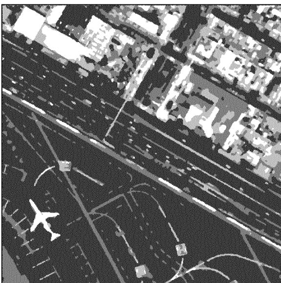
Figura 6.48 Imagen segmentada con una ventana ( v=3 \times 3 ).
