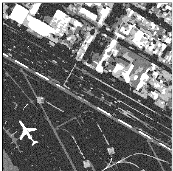
Figura 6.49 Imagen segmentada con dos ventanas ( v=3 \times 3 y v=5 \times 5 ).
