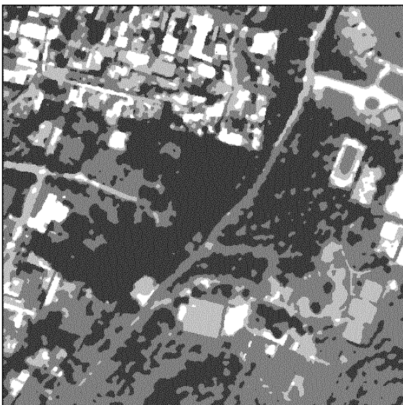
Figura 6.52 Imagen segmentada con una ventana ( v=3 \times 3 ).
