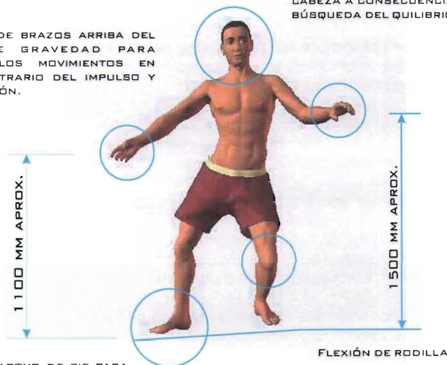
PUNTO DE APOYO DE PIE PARA PODER PIVOTEAR Y DAR DIRECCIÓN AL DESLIZADOR.
