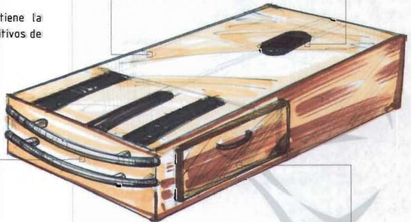
Tubos de metal rolados y cortados, con regatones en sus extremos, sujetos a la estructura interna
