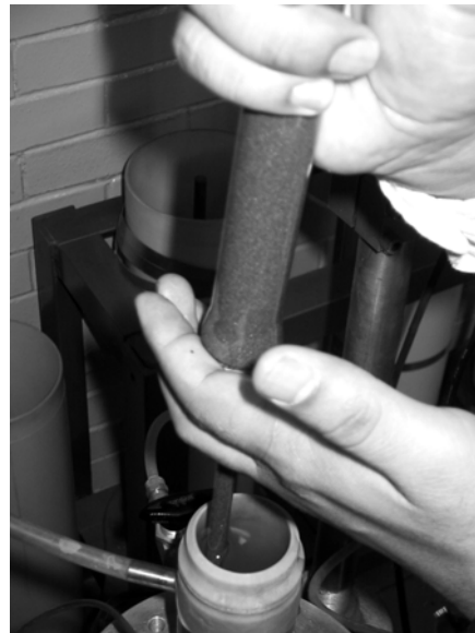
Figura 3.2.6 Colocación del material en el molde partido para formar la probeta
