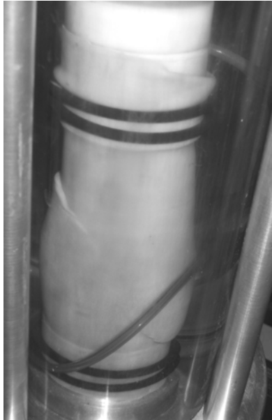
Figura 3.3.3 Plano de falla de probeta
