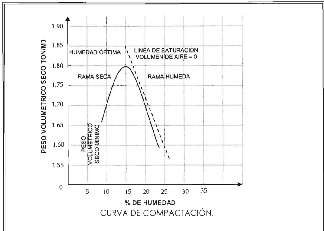
Figura 63. Gráfica de resultado de estudio de compactación típica
