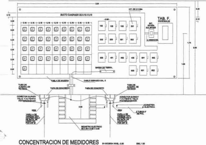
CONCENTRACION DE MEDIDORES EN BOVEDA NIVEL -2.50 ESC. 1:30
