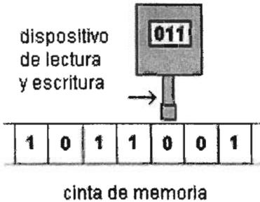
Figura 3.6: Esquema de una máquina de Turing.
