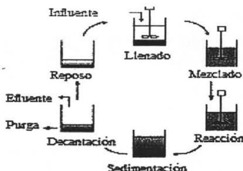
**Figura 6.** Esquema de un proceso cíclico de reactores secuenciales en Batch para la eliminación de nitrógeno. (Gómez, 2000)
