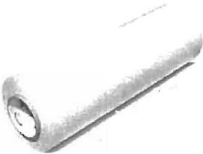
Sticky Back. Material autoadherible con el que se fijan los grabados al cilindro de la placa.
