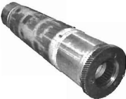
Cilindro de la Placa. El grabado es fijado al cilindro con el Sticky Back
