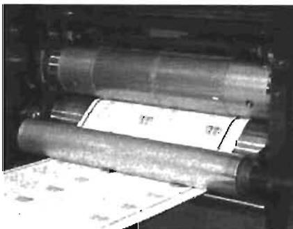
**Suaje:** Es una herramienta que se utiliza para cortar los contornos o límites de un impreso. El sistema más común en flexografía es el de los suajes cilíndricos rotativos. Los elementos básicos son: un rodillo yunque engranado, una ranura para fijación del suaje, un sistema para aplicar y mantener presión sobre el mismo y un dispositivo para remover la tirilla de desperdicio. También hay suajes planos que emplean cuchillas especiales.
