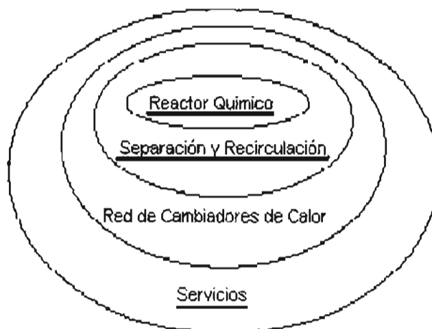
Figura 4.2 Diagrama de cebolla de un Proceso Químico.
