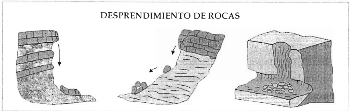
Figura 3.6- Caída y desprendimiento de rocas.
