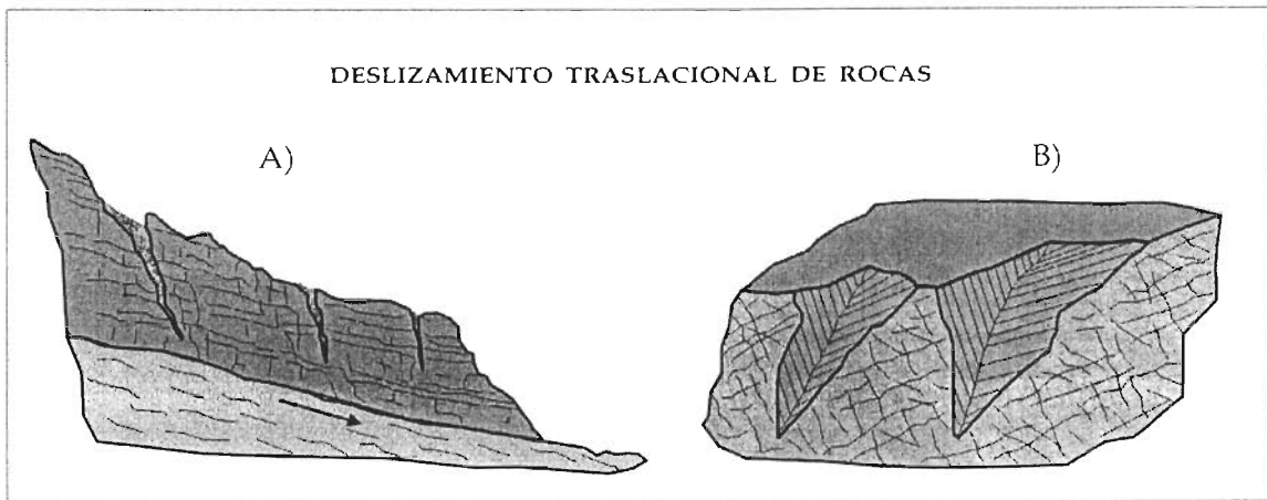
Figura 3.2- Movimiento traslacional A) Deslizamiento plano. B) Deslizamiento en cuña.
