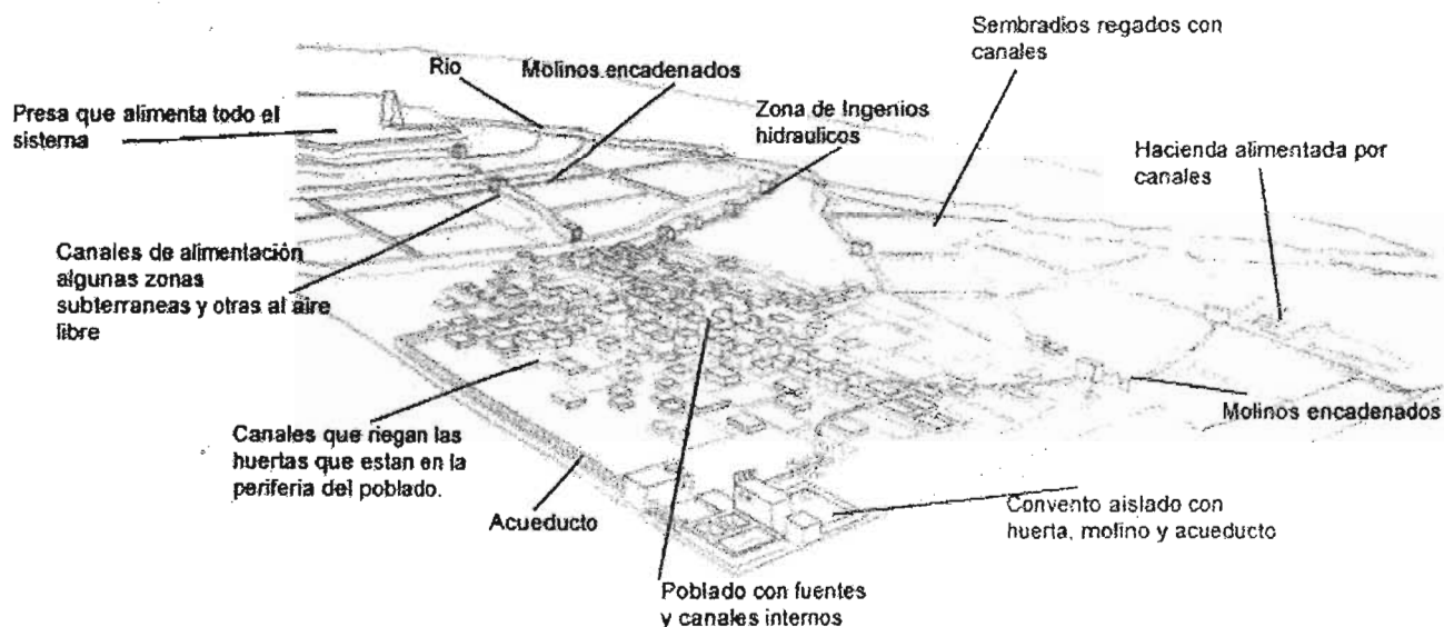
ESQUEMA DE UNA REGION HIDRAULICA
